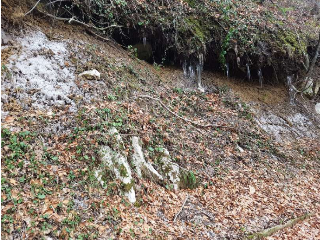
Foto 1 e 2: Gli spessori delle coltri di copertura piroclastica su substrato calcareo classe A (<0,5 m).
